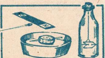
cu diametrul interior al sticlei, pe care o suspenzăți apoi de un dop cu o ață și o piunea, asa cum se vede în figură. Introduceți acul în sticla și fixați dopul. Astfel hîrtia cu acul se poate învîrta liber în interiorul sticlei, permitînd acului să se situeze pe direcția nord-sud. Firește, busola este portabilă.
